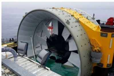
FIGURE 9 : IMMERSION DE L'HYDROLIENNE OPENHYDRO (2016 ©EDF)
