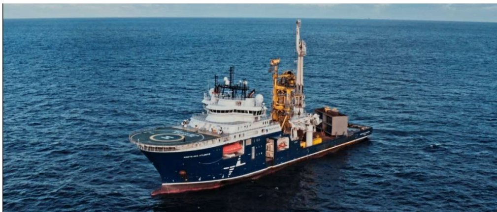
FIGURE 5 : NAVIRE D'INSTALLATION A POSITIONNEMENT DYNAMIQUE UTILISE AU LARGE DE PAIMPOL-BREHAT POUR LA SORTIE DU PROTOTYPE OCEANQUEST EN 2019 - ©HYDROQUEST
